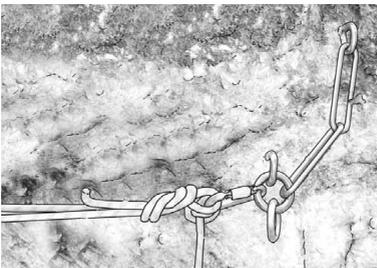
nécessaire de disposer d'un point d'ancrage placé au-delà de l'axe de descente. L'amarrage idéal est constitué de deux points d'ancrage superposé (fig. 80). L'ancrage principal qui supporte le maillon de rappel, permet de fixer la main courante. L'ancrage de secours placé au-dessus, en aval, permet au cadre de stationner sans gêner l'accès à la corde de descente. Cette disposition offre plusieurs avantages :
