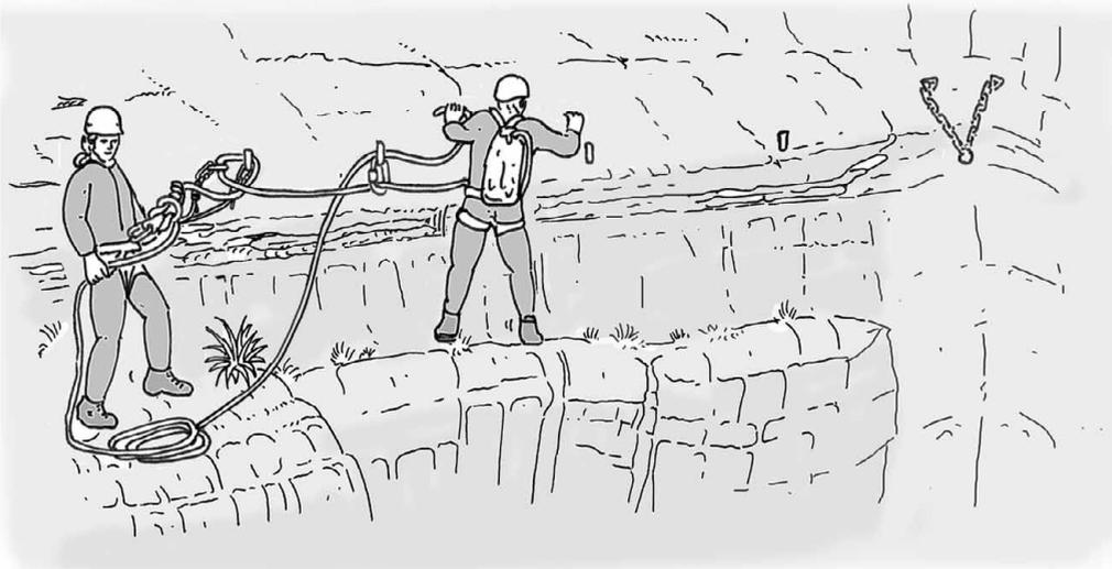
Exemple de technique permettant au premier équipier d'avoir les mains libres pour équiper la main courante (fig. 34) et de disposer du sac de corde une fois parvenu à l'amarrage de tête de cascade.
