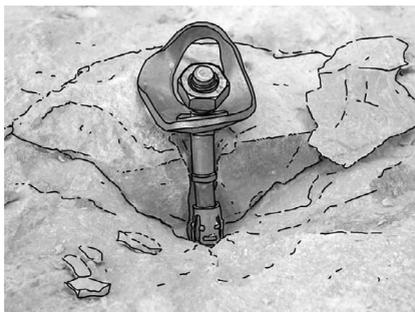
Lors des tests d'arrachement figurant dans les cahier n°11 et 12, dans un calcaire dur et compact, il a été possible d'observer plusieurs fois des ruptures de cônes d'arrachement qui présentaient une dislocation moins importante du rocher. Brisé seulement en deux ou trois parties (fig. 40), il était alors possible de reconstituer le cône d'arrachement en emboitant les morceaux. Le cône peut tout aussi bien céder en totalité ou parti-
