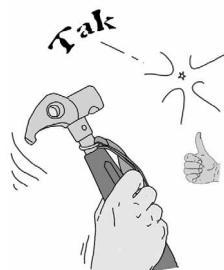
La surface du rocher doit être plane et propre. Éviter les zones recouvertes de calcite ou à défaut, décaper la calcite jusqu'au rocher sain avec la pointe du marteau, retirer également les picots rocheux, ou les petites écailles gênantes. Avant de commencer le trou, s'assurer que la plaquette disposera d'une surface d'appui suffisamment grande et parfaitement plane ; prendre en compte l'axe de travail pour orienter la plaquette dans sa position finale.
