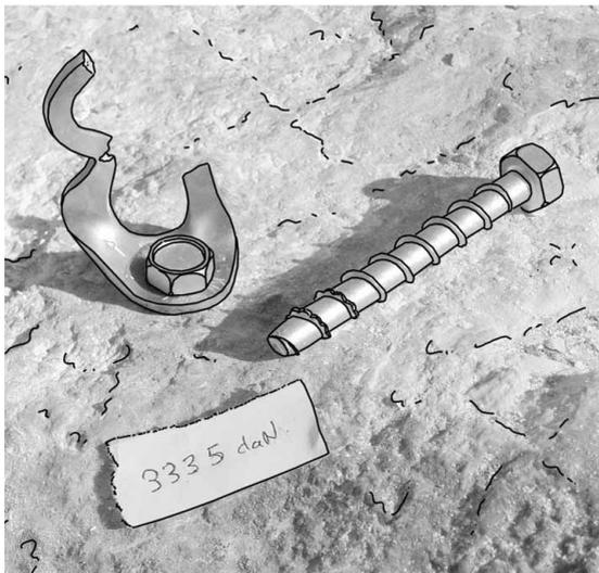
vis à béton Fischer acier FBS 10/5 (gabarit : 12,4 x 98 mm.)
