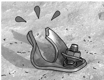
cheville acier à expansion par vissage Spit D12 version ecrou + plaquette Coeur : rupture plaquette 2192 daN.
