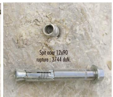
Comportement en traction sur plaquette Coeur PETZL et au cisaillement sur plaquette Rock RAUMER des chevilles hautes performances à expansion par vissage SPIT associées à un anneau Raumer.
