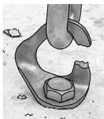
cheville inox à expansion par frappe Hilti M12 + plaquette Coeur : 8 tests, aucune rupture de cheville.
