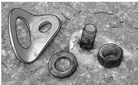
amarrage exposé à la pluie, depuis un peu plus de cinq ans présentant des traces de corrosion avancées sur l'écrou, la rondelle et le goujon en acier zingué, favorisées par une corrosion électrochimique consécutive à la plaquette inox.
