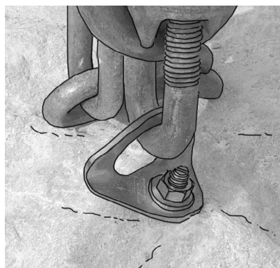
Plaquette Coeur de Petzl montée sur une cheville à expansion par vissage M8 effort de traction : 1401 daN. (la déformation de la plaquette est plus prononcée en raison de la portée plus réduite de l'écrou et de la déformation de l'ancrage).
