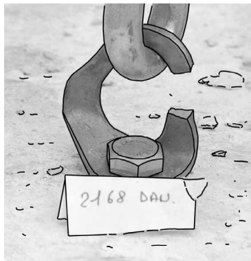
cheville femelle inox Hilti M12 sur plaquette Coeur Petzl : rupture 2168 daN. L'amorce de rupture est provoquée par le marquage de la date de fabrication présent sur les plaquettes récentes (emboutissage).
