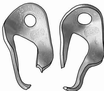
plaquettes Coeur de Petzl : rupture en traction comprises entre 2168 et 4086 daN.
