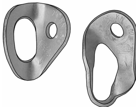
plaquette Coeur de Petzl neuve puis après un effort de cisaillement de 4126 daN.
