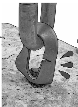
amorce de rupture
