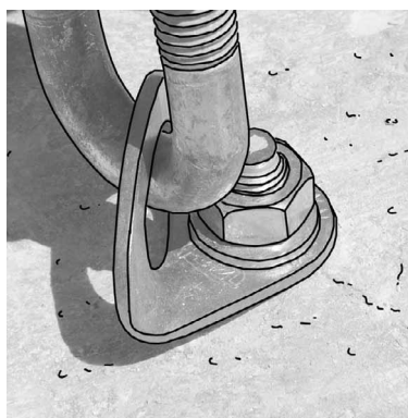
Plaquette Coeur de Petzl efforts de traction : 1506 daN. (la bonne tenue de la plaquette est favorisée par la dimension du goujon M12 et de la rondelle large).
