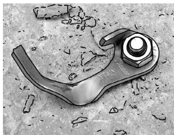
plaquette Raumer Rock; rupture au cisaillement comprise entre 2961 et 3726 daN.
