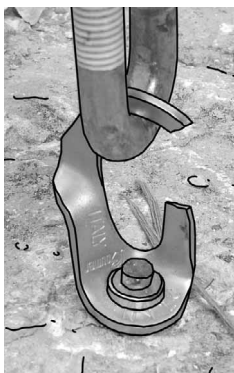
ancrage Full Time (plaquette Rock Raumer) valeur de rupture maximale observée en traction: 2575 daN. mini 1819 daN.
