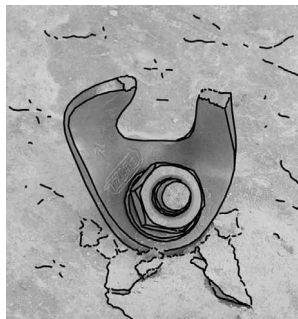
plaquettes Coeur de Petzl (fabrication antérieure à 2000 : rupture en traction 4086 daN.
