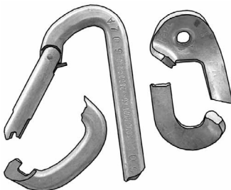
zicral : supporte mal les déformations et se casse brutalement.
