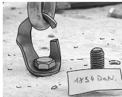
cheville femelle inox Hilti M12 sur plaquette Rock Raumer valeur de rupture en traction 1854 daN.
