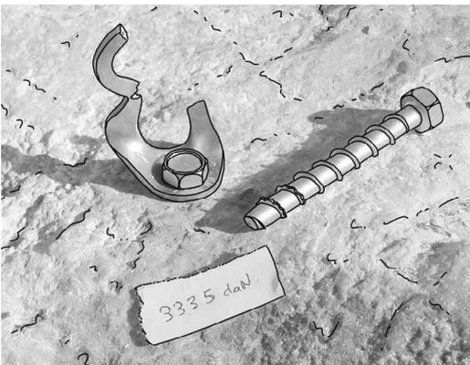
vis à béton Fischer acier FBS 10/5 (gabarit : 12,4 x 98 mm)
