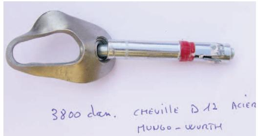
Sélection de photos du test de résistance des chevilles hautes performances à expansion par vissage MUNGO, Pascal MKT et WURTH.
