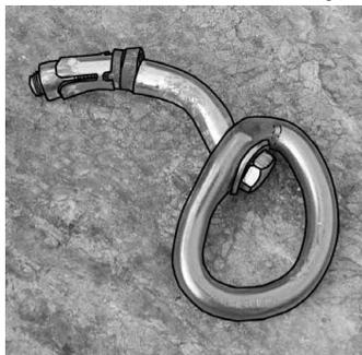
déchaussement au cisaillement cheville à expansion par vissage Mungo et Wurth acier D12 : 4167 daN.
