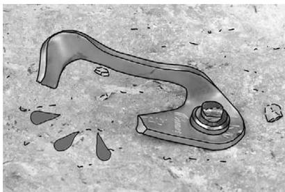
rupture ancrage Full Time Maxi Raumer à 3605 daN. fin du test.
