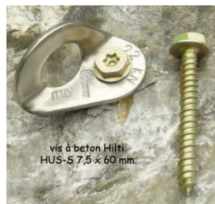
Sélection de photos du test de résistance des vis à béton en traction sur plaquette.
