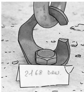
cheville femelle inox Hilti M12, rupture plaquette Coeur Petzl : 2168 daN. L'amorce de rupture est provoquée par le marquage de la date de fabrication présent sur les plaquettes récentes (emboutissage).
