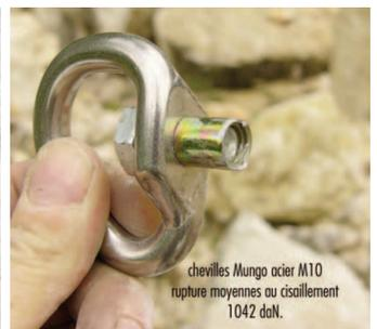
Sélection de photos des tests de résistance des chevilles femelles à expansion par frappe de différentes marques en traction.
