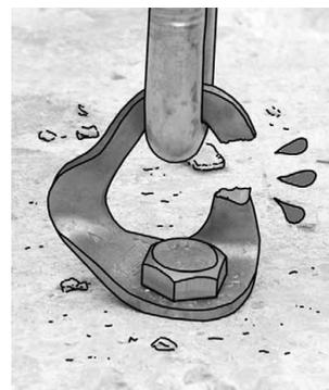
Une cheville femelle inox M12 Hilti à était abandonnée sur place malgré 7 ruptures de plaquettes et une valeur de résistance maximale de 3458 daN.
