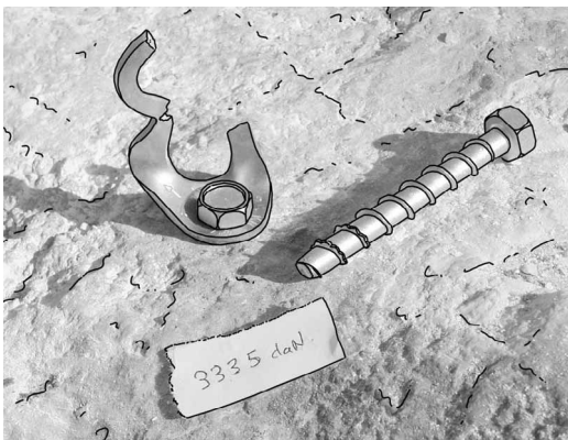
vis à béton Fischer acier FBS 10/5 (gabarit : 12,4 x 98 mm) rupture systématique des plaquettes
