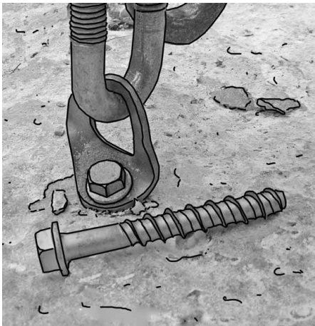
vis à béton Hilti HUS-S 12,5 X 85 mm (perçage 10 mm) effort 3000 daN
