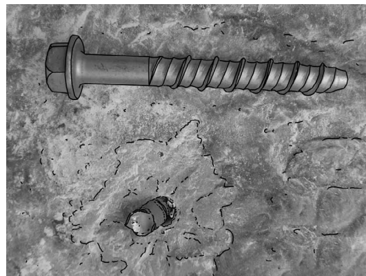
vis à béton Hilti HUS-S 10,5 X 75 mm (perçage 8 mm) rupture au cisaillement 2480 daN
