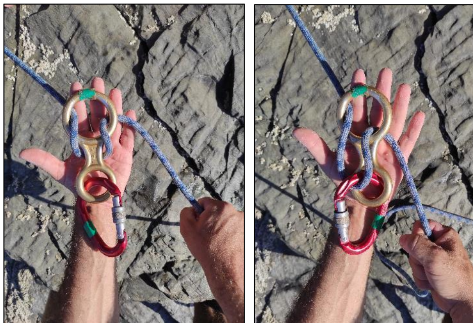
Discensore a otto con corda per la calata inserita: in configurazione da calata standard (a sinistra) e in modalità otto veloce (a destra) per la discesa lungo la teleferica
