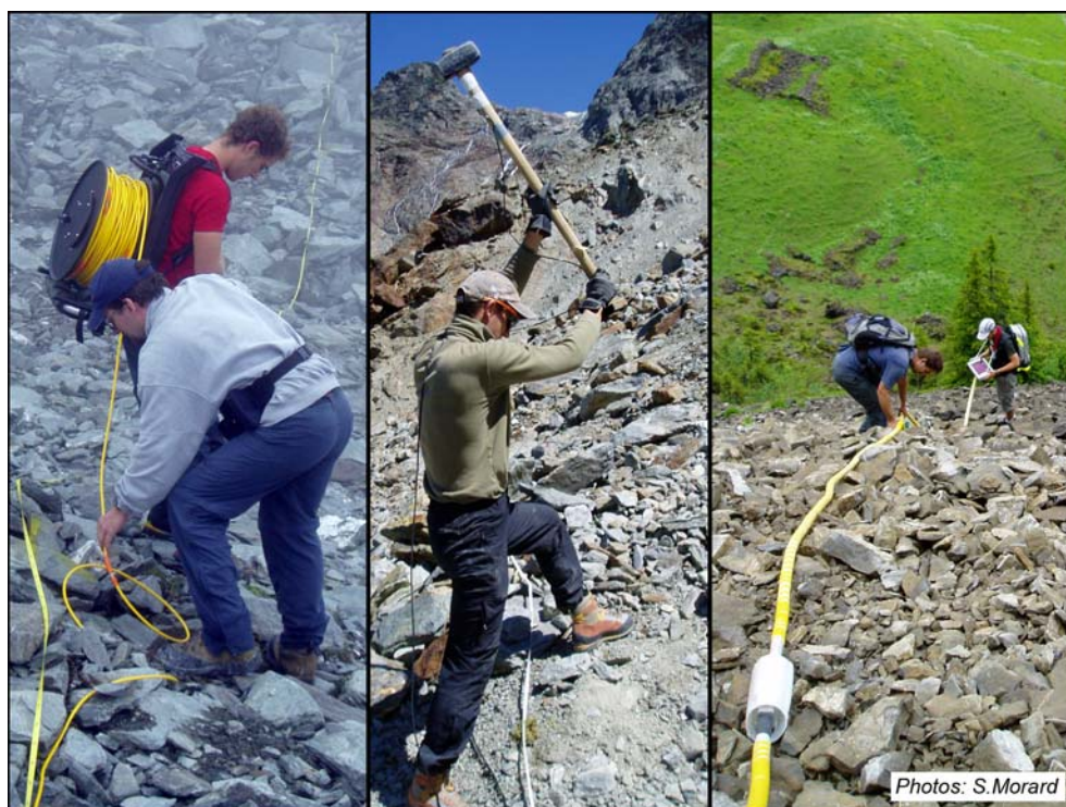
Fig. 5 – Application de méthodes géophysiques en milieu alpin : installation d'un profil de géoélectrique (à g.), sismique-réfraction au marteau (au centre) et géoradar (à d.).
