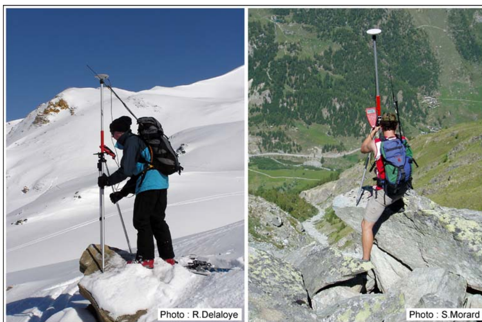
Fig. 1 – Suivi par GPS des mouvements de glaciers rocheux (à gauche : Becs-de-Bosson (Réchy, VS) ; à droite : Tsarmine (Val d'Arolla, VS)).
