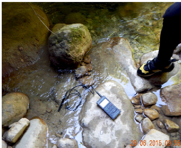
Figure 3 : Mesure de la conductivité électrique et de la température de l'eau au cours de la progression dans le canyon.
