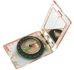
Un exemple de boussole à plaquette repliable et système de visée par miroir →
