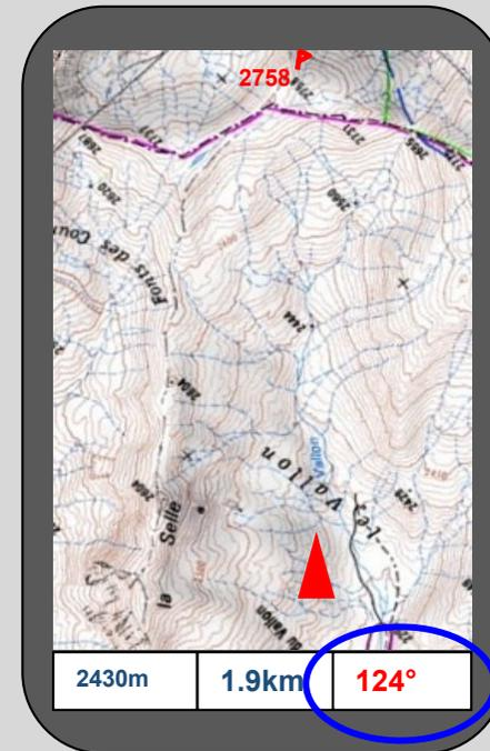
**2/** Avec une boussole, avec l'azimut donné par le GPS, viser le point.
