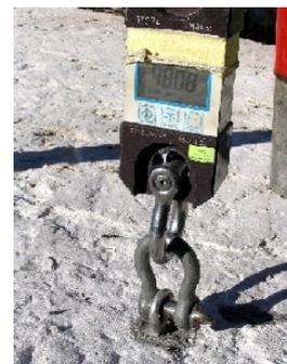
Nous avons ensuite posé 6 goujons de 10mm de nature variée (longueur, simple et double expansion) que nous avons arraché à l'aide d'une plaquette. L'effort exercé sur la tête du goujon par le vérin, via la plaquette, faisait apparaître un couple. La mise en œuvre de notre essai n'était donc pas adaptée, la tête des goujons a alors cédé
